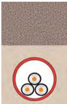
Si el cable estuviera **enterrado bajo tubo** la intensidad admisible se ve reducida en un 25 % en las nuevas condiciones estándares.
